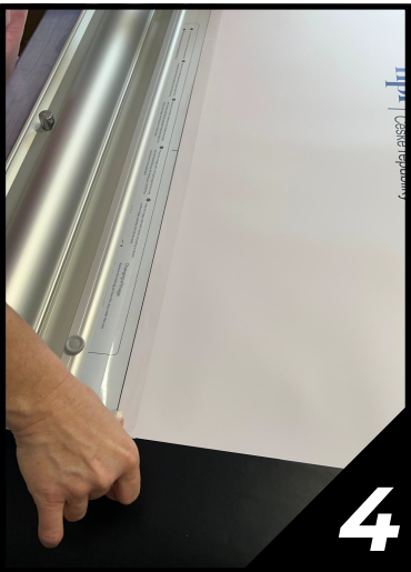
4. Motív nasadíte na lepiacu časť. Odporúčame prekryť lepiacou páskou, aby sa tak zabránilo vytrhnutiu tlačne.
